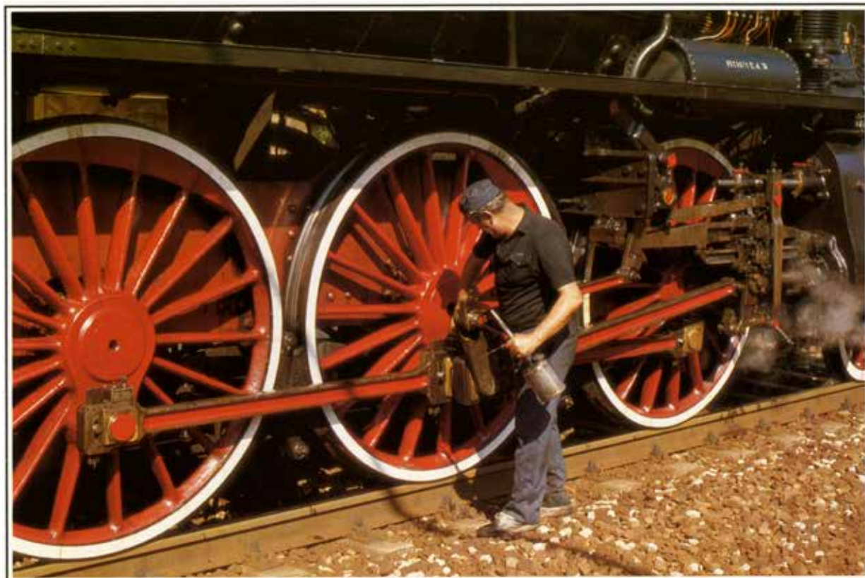
685 196 - 1982 - Il macchinista e la sua macchina - Il macchinista, prima di uscire dal Deposito Locomotive, rabocca di olio le vaschette del biellismo alla 685 196. Notare l'altezza delle ruote di 1850 mm di diametro. (foto di Giancarlo Ganzerla - Deposito Locomotive Verona, 1982)
